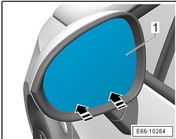
Colocar la palanca extractora -3370- sujetando la parte posterior del espejo retrovisor exterior -1-, tal y como se muestra en el gráfico.
